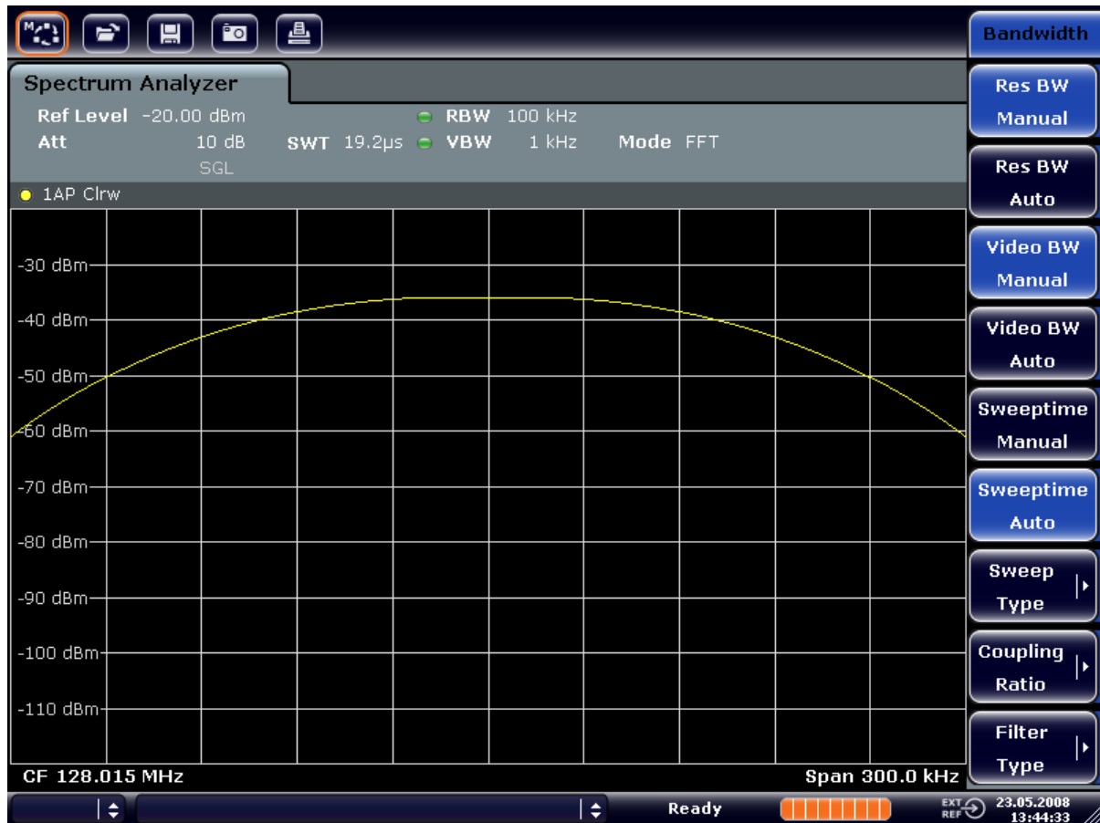
Рис. 6-5: Измерение двух синусоидальных ВЧ-сигналов одинакового уровня с полосой разрешения, большей, чем разнос их частот
